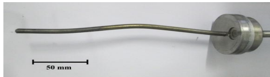
Деформация стального чехла термопары из-за напряжений внутри засыпки
